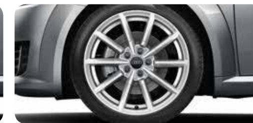
Llantas de aleación de aluminio con diseño de 10 radios tamaño 8,5 J x 18 con neumáticos 245/40 R 18 1
