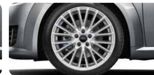
Llantas de aleación de aluminio con diseño de 20 radios en V tamaño 8,5 J x 18 con neumáticos 245/40 R 18 1
