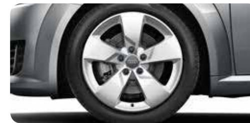
Llantas de aleación de aluminio con diseño de 5 brazos tamaño 8 J x 17 con neumáticos 225/50 R 17 1
