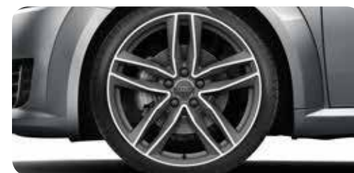
Llantas de aleación de aluminio Audi Sport con diseño de 5 radios dobles en estética de titanio mate, abrigantadas 2 tamaño 9 J x 19 con neumáticos 245/35 R 19 1 . Oferta de quattro® GmbH
