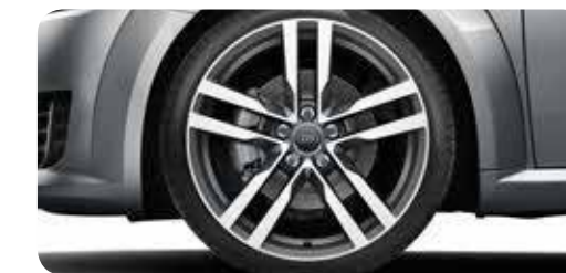
Llantas de aluminio con diseño de 5 brazos en estrella gris contraste, parcialmente pulidas 2 , tamaño 9 J x 19 con neumáticos 245/35 R 19 1
