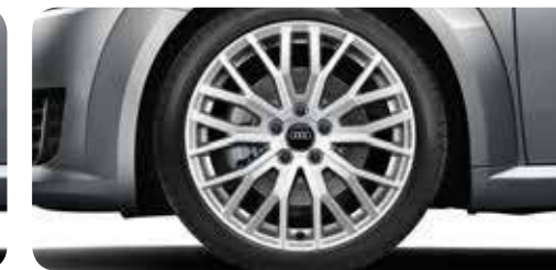
Llantas de aleación de aluminio con diseño de 10 radios en V parcialmente pulidas 2 , tamaño 8,5 J x 18 con neumáticos 245/40 R 18 1,3
